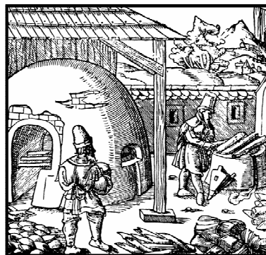
třibící pec na čištění stříbra podle Agricoly
