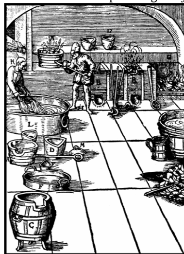
zrnárna (zrnění mědi přes košťata) podle Erckera
