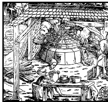
sháněcí pec na přepalování stříbra podle Agricoly
